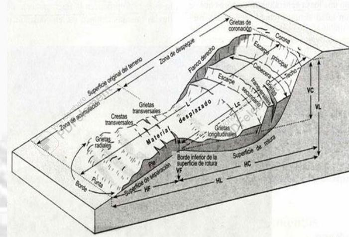
Imagen 29 Partes de un deslizamiento rotacional
